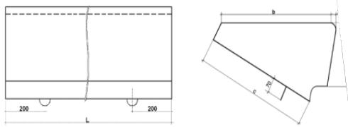
Предназначены для устройства внутренних и наружных лестниц зданий и сооружений
